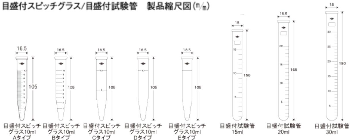
目盛付スピッチグラス/目盛付試験管 口形状:ニューリップ(NL)(W/Rim)規格価格表
